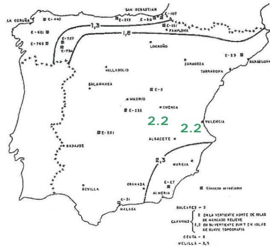
Figura 7.- Mapa del coeficiente corrector del umbral de escorrentía (modificación CEDEX 1994).
